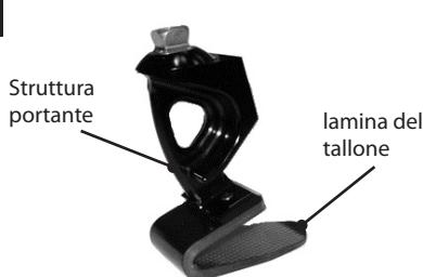
Montare la lamina del tallone sul supporto, utilizzando Loctite 243 (926012) e stringere a 15Nm. Utilizzare la speciale chiave a brugola 940080, l'adattatore della chiave dinamometrica 940081 oppure la chiave 13A/F 940273.
