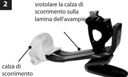
Far scorrere la lamina dell'avampiede sulla struttura portante (non montare i bulloni). Piegare la calza accuratamente attorno all'estremità dell'avampiede.
