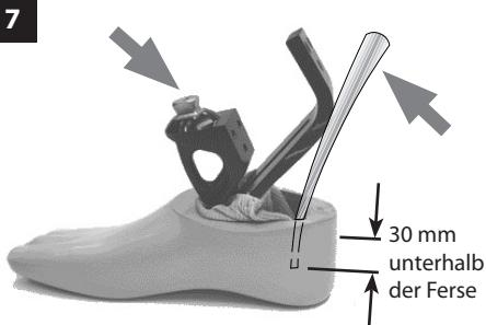
Schieben Sie einen metallenen Schuhanzieher zwischen Fersenfeder und die Rückseite der Fußkosmetik und hebeln Sie die Feder in die Fußkosmetik.
