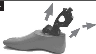
tourner l'ensemble support/lame de talon vers l'arrière du pied pour dégager la lame de son emplacement dans l'enveloppe.
