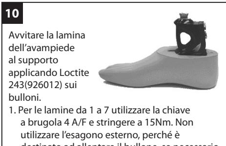
1. Per le lame da 1 a 7 utilizzare la chiave a brugola 4 A/F e stringere a 15Nm. Non utilizzare l'esagono esterno, perché è destinato ad allentare il bullone, se necessario.
