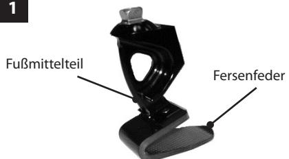
Befestigen Sie die Fersenfeder am Fußmittelteil. Befestigungsschrauben mit Loctite 243 (926012) und einem Dremoment von 15 Nm sichern. Benutzen Sie den speziellen Sechskantschlüssel 940080, den Drehmoment Adapter 940081 oder den 13 mm Ringschlüssel 940273.
