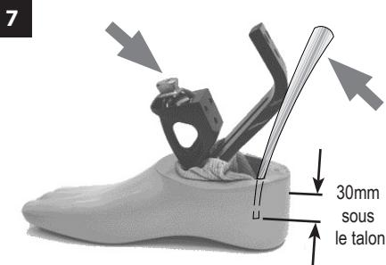
Faire glisser un chausse-pied métallique entre la lame de talon et l'arrière de l'ouverture de l'enveloppe de pied puis faire levier pour enfoncer la lame dans l'esthétique
