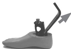
Entfernen Sie die Befestigungsschrauben für die Vorfußfeder vom Fußmittelteil und ziehen Sie die Vorfußfeder rückwärts aus der Fußkosmetik.
