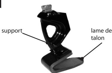
Assembler la lame de talon sur le châssis, avec de la Loctite 243(926012) et serrer à 15Nm. Utiliser la clé Allen spéciale 940080, l'adaptateur 940081 ou 13 A/F 940273.
