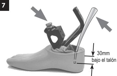
Deslice un calzador metálico entre el resorte del talón y la parte trasera de la apertura de la carcasa del pie y haga palanca para colocar la ballesta dentro de la carcasa.
