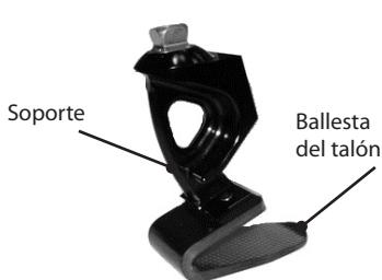
Ensamble la ballesta del talón sobre el soporte, use Loctite 243(926012) y torque hasta los 15Nm. Use una llave Allen especial 940080, torque con la llave adaptadora 940081 o con la llave 13 A/F 940273.
