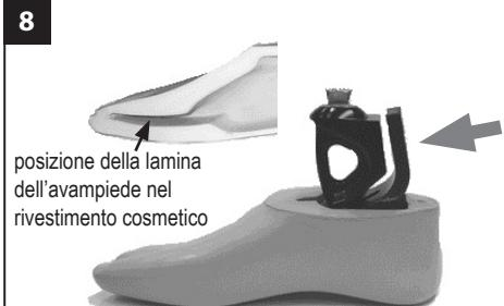
Spingere la lamina dell'avampiede verso il supporto. Assicurarsi che la calza di scorrimento non resti intrappolata tra la lamina e il supporto. Inserire la lamina nell'apposita sede
