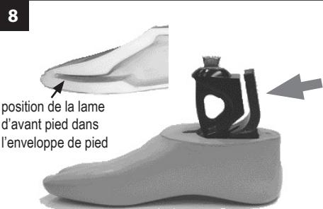
Pousser la lame d'avant pied vers le support. Vérifier que la chaussette de protection n'est pas prise entre la lame et le support. Pousser la lame en place dans l'enveloppe
