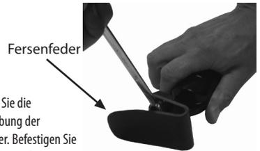
Entfernen Sie die Verschraubung der Fersenfeder. Befestigen Sie die neue Fersenfeder an der Halterung. Die Fersenfeder mit dem Mittelteil verschrauben. Benutzen Sie den speziellen Schraubenschlüssel 940080, den Drehmoment Adapter 940081 oder den 13 A/F Schraubenschlüssel 940273. Die beiden Schrauben sind mit 15 Nm anzuziehen und mit Loctite 243 verwenden
