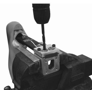
Haga dos agujeros de 8,1mm de diámetro a través de las guías de perforación.
