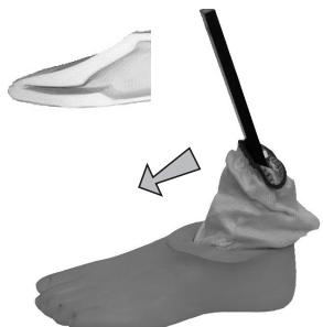
Coloque el ensamblaje enganchando la punta de la ballesta en la ranura interna de la cubierta cosmética del pie
