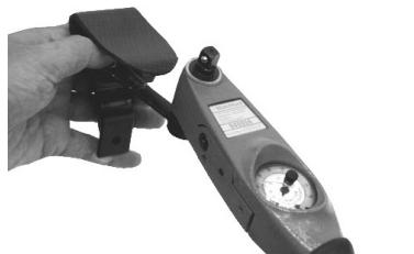
Setzen Sie die neue Fersenfeder ein, sichern Sie die Schrauben mit Loctite (243) und ziehen Sie diese mit einem Anzugsdrehmoment von (15Nm) an. Benutzen Sie den Drehmomentschlüssel 940081.
