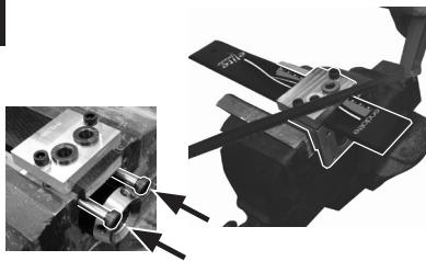
Entfernen Sie den Schaft. Befestigen Sie die Montageklammer im Schraubstock und schneiden Sie das Prothesenteil für die endgültige Länge zurecht. Verwenden Sie Zapfenschrauben um Beschädigungen an den Komponenten zu vermeiden.
