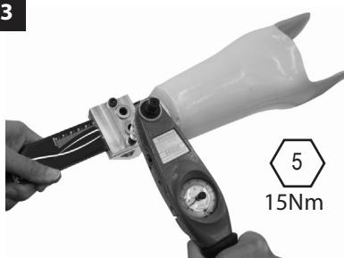
Apriete los tornillos del soporte superior para prueba a 15Nm (compruebe cada tornillo al menos dos veces).
