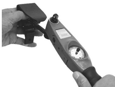
Montare la nuova lamina del tallone, Loctite (243) e serrare i bulloni (15Nm). Utilizzare l'accessorio 940081 della chiave di serraggio dinamometrica)
