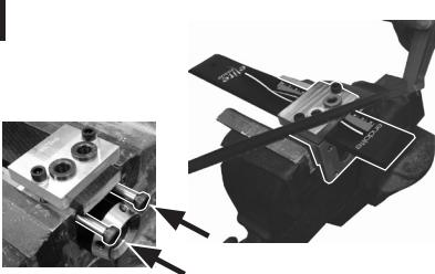
Quite la tuerca, ponga el soporte superior de prueba en el tornillo de banco y corte la ballesta tibial a la longitud necesaria.
