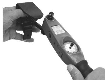
Coloque la ballesta de talón nueva, con Loctite (243) y apriete los tornillos (15Nm). Utilice la llave inglesa del par de torsión (940081).
