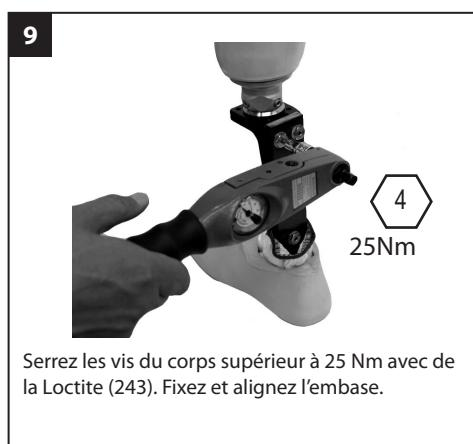
Serrez les vis du corps supérieur à 25 Nm avec de la Loctite (243). Fixez et alignez l'embase.
