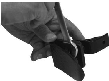
Entfernen Sie die Fersenfeder vom Mittelteil (13mm Schraubenschlüssel 940273)
