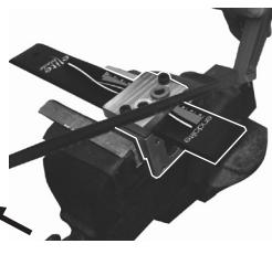
Rimuovere l'ancoraggio, sistemare la staffa di montaggio nella morsa e tagliare il pilone alla lunghezza richiesta. Montare due viti lunghe per evitare di danneggiare i componenti.
