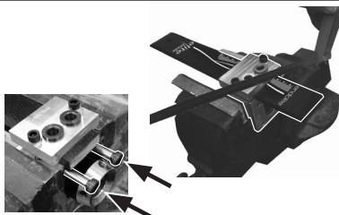
Démontez au niveau de la pyramide, placez l'outil de montage dans un étau et coupez la lame à la longueur (la partie supérieure de l'outil servira de guide). Utilisez les vis épaulement pour éviter d'endommager les composants.
