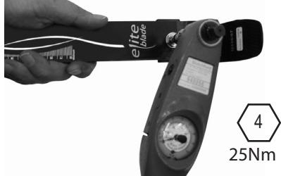
Fissare la lamina al supporto tallone. Loctite (243) e serrare i bulloni (25Nm).
