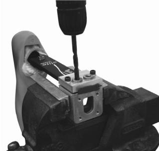
...e praticare due fori del diametro di 8,1 attraverso le boccole di foratura.
