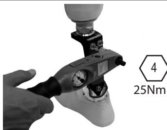
Tagliare la lamina seguendo il metodo precedentemente illustrato prima di fissare l'alloggiamento superiore. Loctite (243) e serrare i bulloni (25Nm). Eventualmente, applicare di nuovo l'estetico.
