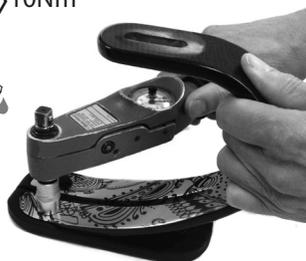
Monte la ballesta de la punta del pie en la cubierta de la ballesta del talón y apriete los pernos 10 Nm.
