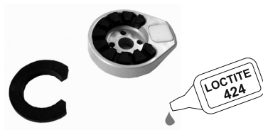
fig 2. Amortisseur moyen en place
