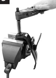
Подсоедините пружину мыска к несущей сборке стопы, на крепежные болты нанесите резьбовой фиксатор «Loctite 243» (926012)
