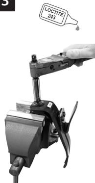
Una la ballesta de la puntera a la transportadora utilizando Loctite 243 (926012) en los pernos.
