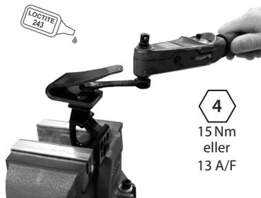
Bruk spesial-unbrakonøkkel 940080, momentnøkkeladapter 940081 eller 13A/F-skiftenøkkel 940273. Bruk Loctite 243 (926012) og et moment på 15 Nm.
