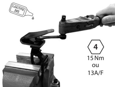
Utilisez la clé hexagonale spéciale 940080, l'adaptateur de clé dynamométrique 940081 ou la clé 13A/F 940273. Appliquez de la Loctite 243 (926012) et serrez au couple de 15 Nm.
