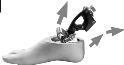
Gire el conjunto de la transportadora/ballesta para el talón hacia la parte trasera del pie para desencajar la ballesta de su ubicación en la cubierta.
