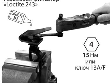
Используйте специализированный шестигранный ключ 940080, адаптер динамометрического ключа 940081 или 13 А/Ф комбинированный гаечный ключ 940273. Нанесите резьбовой фиксатор Loctite 243 (926012) и затяните с усилием 15 Нм.
