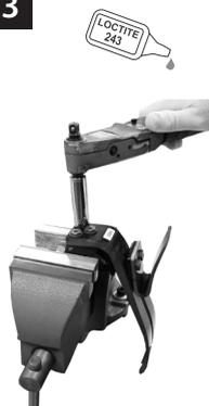
Fixez la lame d'avant-pied au support avec de la Loctite 243 (926012) sur les boulons.
