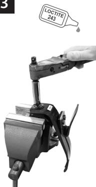
Collegare la lamina anteriore al supporto applicando sui bulloni del Loctite 243 (926012).
