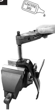
Cıvatalar üzerinde Loctite 243 (926012) kullanarak ayak parmağı yayını taşıyıcıya takın. 1. 1 ila 7 arasındaki yay değerleri için, 4 A/F Alyen anahtar kullanın ve 15 Nm torkla sıkın. Haricî altıgen anahtarı kullanmayın; bu anahtar, gerekirse cıvatanın gevşetilmesi için ayrılmıştır. 2. 8 ve 9 yay değerleri için, 13 A/F Alyen anahtar kullanın ve 25 Nm torkla sıkın.
