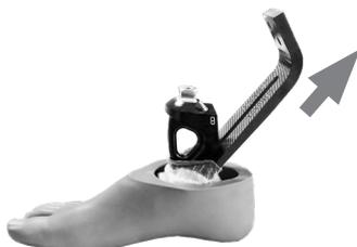
Отвинтите крепежные болты на несущей сборке стопы и вытяните пружину мыска в направлении к задней части стопы.
