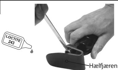
Løsne og fjern hælfjærskruene. Monter ny hælfjær på ankelen, bruk Loctite 243 (926012) og et moment på 15 Nm. Bruk spesial-unbrakonøkkel 940080, momentnøkkeldapter 940081 eller 13A/F-skiftenøkkel 940273
