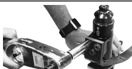
Подсоедините пружину мыска к несущей стопы, на резьбу крепежных болтов следует нанести небольшое количество резьбового фиксатора «Loctite 243» (шифр 926012). 1. Для набора пружин с жесткостью с 1 по 7 используйте ключ 4 A/F и затяните крепежные болты с усилием 15Нм. Не используйте накидной шестигранный ключ, который применяется при необходимости только для отвинчивания крепежных болтов.
