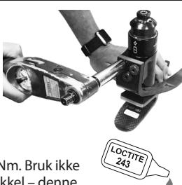
1. For fjærkategori 1 til 7, bruk 4 A/F-unbrakonøkkel og et moment på 15 Nm. Bruk ikke ekstern sekskantnøkkel – denne skal kun brukes til å løsne bolten, hvis nødvendig.
