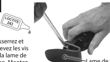
Desserrez et enlevez les vis de la lame de talon. Montez une nouvelle lame de talon sur le support et utilisez de la Loctite 243 (926012) et serrez à un couple de 15 Nm. Utilisez la clé hexagonale spéciale 940080, l'adaptateur de clé dynamométrique 940081 ou la clé 13A/F 940273.
