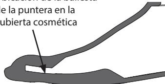
Asegúrese de que la ballesta de la puntera se encaja correctamente en la ranura de ubicación de la cubierta cosmética.
