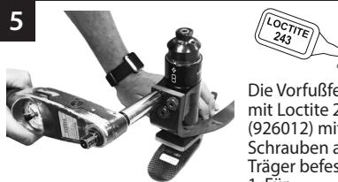
Die Vorfußfeder mit Loctite 243 (926012) mit Schrauben am Träger befestigen.
