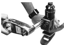
Una la ballesta de la puntera a la transportadora utilizando Loctite 243 (926012) en los pernos.
