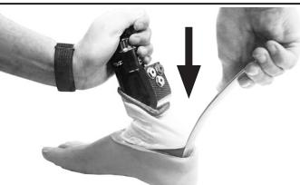
Topuk yayı ve ayak kılıfı açılığının arka kısmına metal bir ayakkabı çekerceği yerleştirin. Tüm tertibati aşağı doğru iterken, aynı anda yayı ayak kılıfı içeresine doğru aşağı yönde bastırın.
