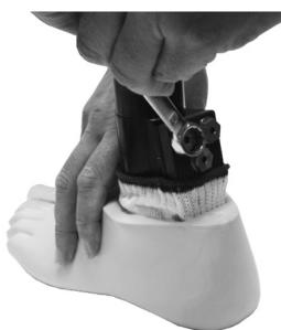
Die Befestigungsschraube für die Vorfußfeder entfernen (13A/F-Schraubenschlüssel 940273).
