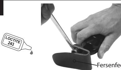
Die Schrauben der Fersenfeder lösen und entfernen. Neue Fersenfeder mit Loctite 243 (926012) und einem Drehmoment von 15 Nm auf den Träger montieren. Speziellen Innensechskantschlüssel 940080, Adapter für Drehmomentschlüssel 940081 oder 13A/F-Schraubenschlüssel 940273 verwenden.
