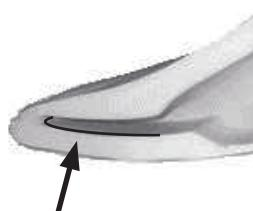
Posizione della lamina anteriore all'interno del rivestimento del piede.
