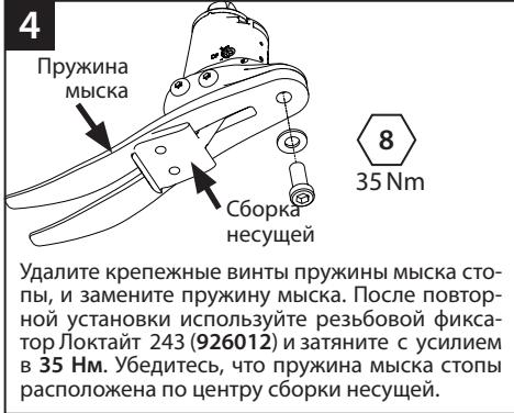
Удалите крепежные винты пружины мыска стопы, и замените пружину мыска. После повторной установки используйте резьбовой фиксатор Локтайт 243 (926012) и затяните с усилием в 35 Нм. Убедитесь, что пружина мыска стопы расположена по центру сборки несущей.
