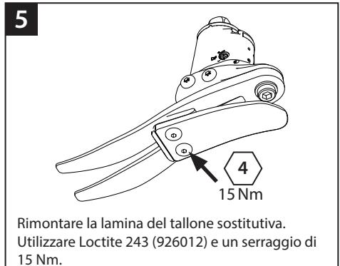
Rimontare la lamina del tallone sostitutiva. Utilizzare Loctite 243 (926012) e un serraggio di 15 Nm.
