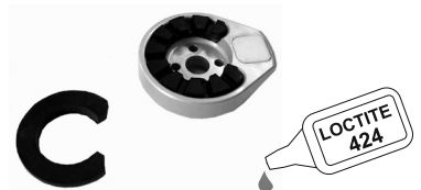
Abb 2. Mit eingefügtem mittleren Puffer
