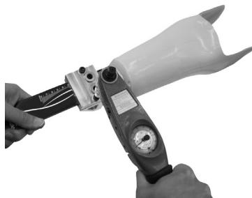
Apriete los tornillos del soporte superior para prueba a 15 Nm (compruebe cada tornillo al menos dos veces).
