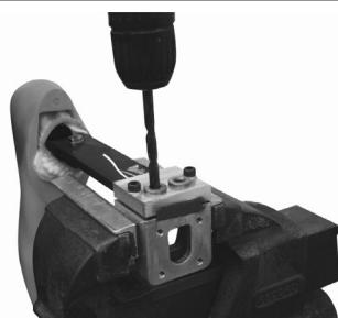
Haga dos agujeros de 8,1 mm de diámetro a través de las guías de perforación.
