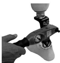
Apriete los tornillos del soporte superior (25 Nm) sellándolos con Loctite (243). Coloque y alinee el soporte piramidal.
