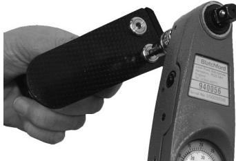
Monte la ballesta del talón en el soporte, use Loctite 243 (926012) y apriete hasta los 15 Nm.
