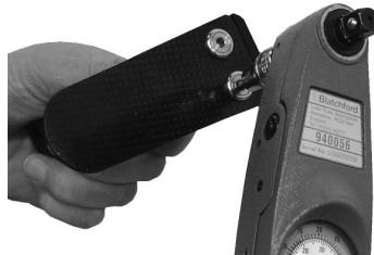
Montare la lamina posteriore sul supporto, utilizzare il Loctite 243 (926012) e avvitare a 15 Nm.
