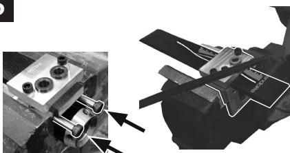
Quite la tuerca, ponga el soporte superior de prueba en el tornillo de banco y corte la ballesta tibial a la longitud necesaria. Coloque los tornillos para prevenir daños en los componentes.
