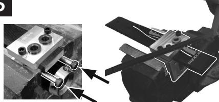
Entfernen Sie den Schaft. Befestigen Sie die Montageklammer im Schraubstock und schneiden Sie das Prothesenteil für die endgültige Länge zurecht. Verwenden Sie Zapfenschrauben um Beschädigungen an den Komponenten zu vermeiden.
