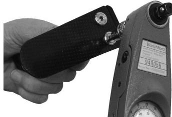
Montez la nouvelle lame de talon, appliquez de la Loctite (243) et serrez les vis (15 Nm).
