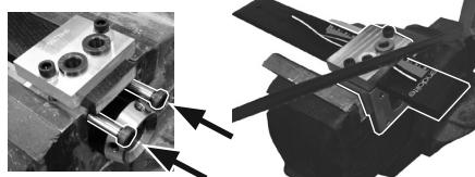
Démontez au niveau de la pyramide, placez l'outil de montage dans un étai et coupez la lame à la longueur (la partie supérieure de l'outil servira de guide).
