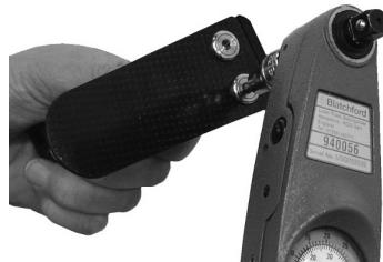
Befestigen Sie die Fersenfederung an den Träger, verwenden Sie Loctite 243 (926012) und drehen Sie bis 15 Nm
