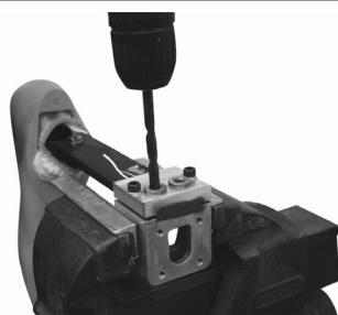
... und bohren Sie zwei Löcher mit 8,1 mm Durchmesser an den vorgesehenen Stellen.
