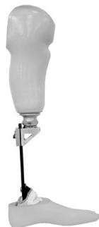
Fügen Sie den Schaf t und die Montageklammer zusammen und ziehen Sie die Pyramidenschrauben an (15 Nm). Prüfen Sie die Aufbaurichtlinie gemäß Grundaufbau.
