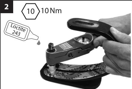
Installez la lame d'avant pied dans l'emplacement de la lame de talon et serrez les boulons à un couple de 10 Nm.
