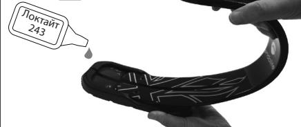
Установите пружину мыска в подошву пружины пятки и затяните болты с усилием в 10 Нм.
