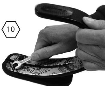
Отверните 2 крепежных болта пяточной пружины.
