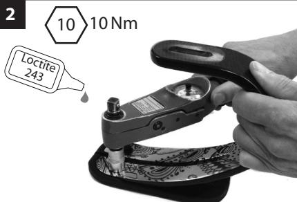
Installare la lamina dell'avampiede nel rivestimento della molla del tallone e serrare i bulloni a 10 Nm. Rimontare il cuneo se era stato installato.
