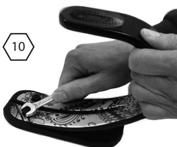
Desserrez les 2 boulons de maintien de la lame de talon.
